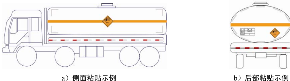
图 A.10 运输剧毒化学品或爆炸品的罐式货车粘贴示例
