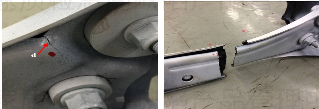
图 4.3-1 加装衬后纵臂纵向拉压疲劳试验中的裂纹扩展情况
