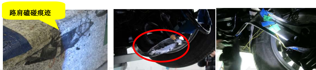
图 3.4-1 K15B0-1 试验后弹簧托架与路肩的碰撞痕迹
