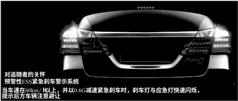
图 6-5 ESS 紧急制动警示系统
